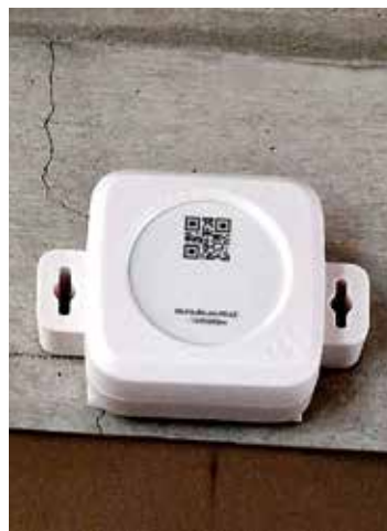
Dieser Beacon oberhalb des Fahrstuhls im Bürgerhaus meldet sich automatisch bei Nutzung der App
