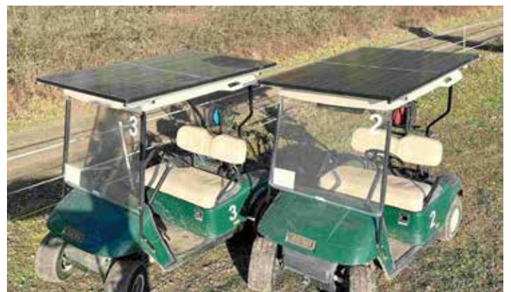
Die beiden E-Buggy mit PV-Panel.
