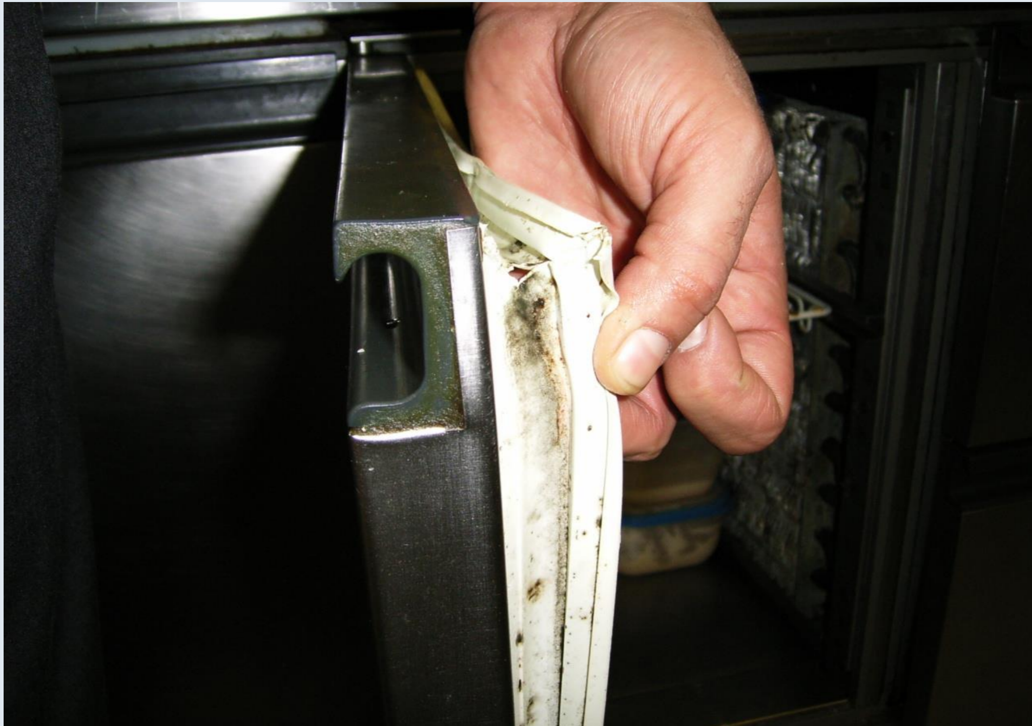
Versporete und beschädigte Kühlschrankdichtung
